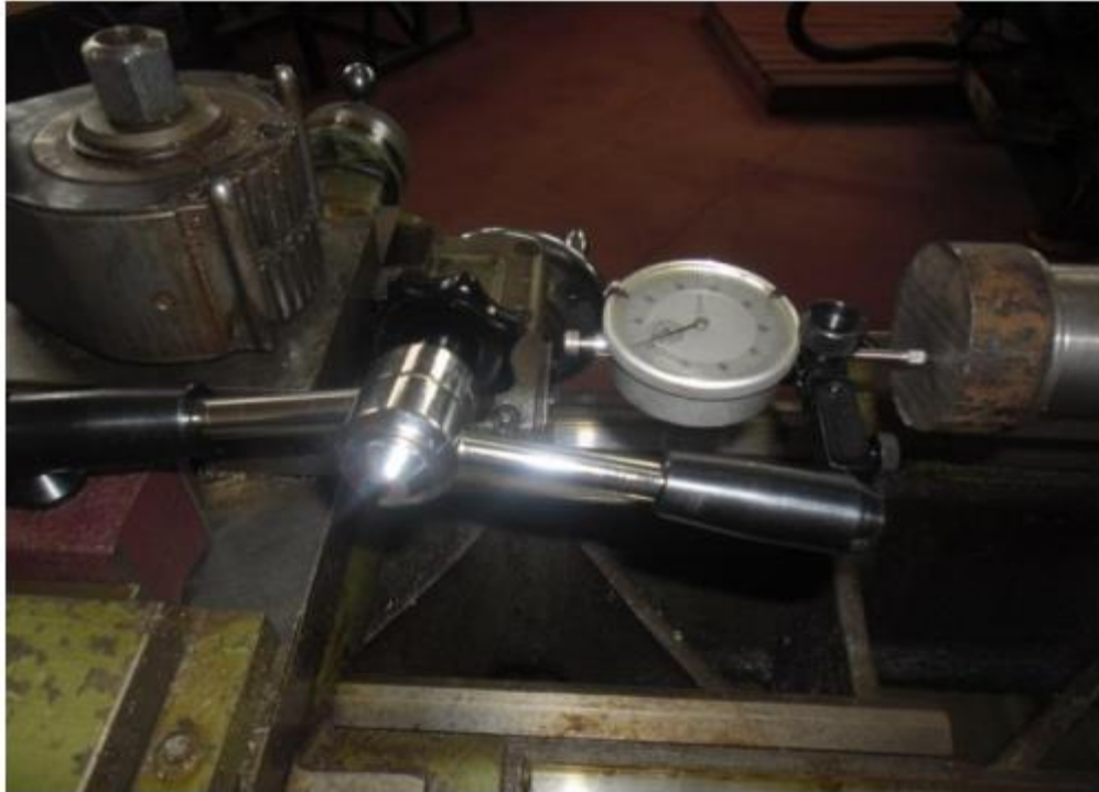
Fig.III.12.Prise des écarts de mise en position. [23]
