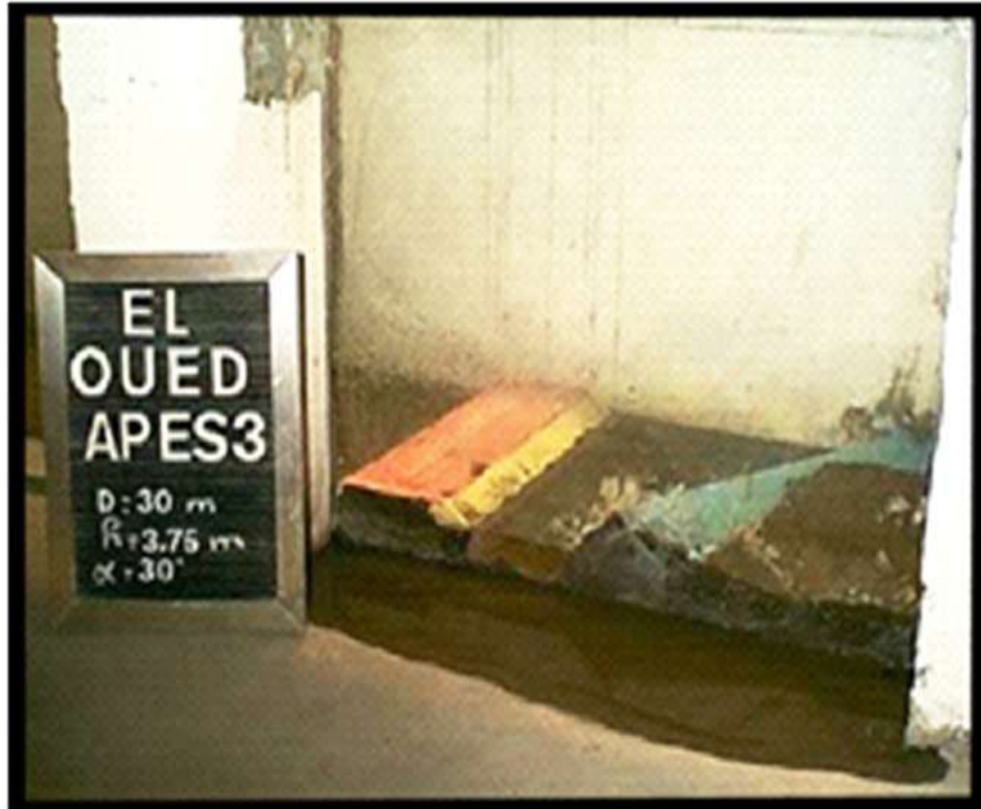
(a) Sur modèle réduit, l'implantation d'un obstacle (Drâa) en biaié par rapport à la route
