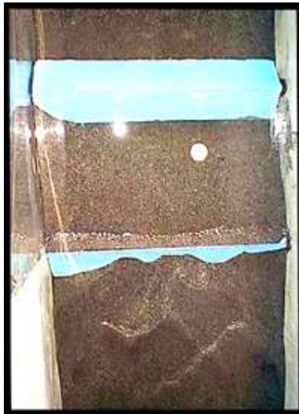
Figure (14a). Sur modèle réduit. L'efficacité de l'implantation de deux Drâas placées parallèlement à la chaussée, une quantité de sable est piégée par le Drâas.
