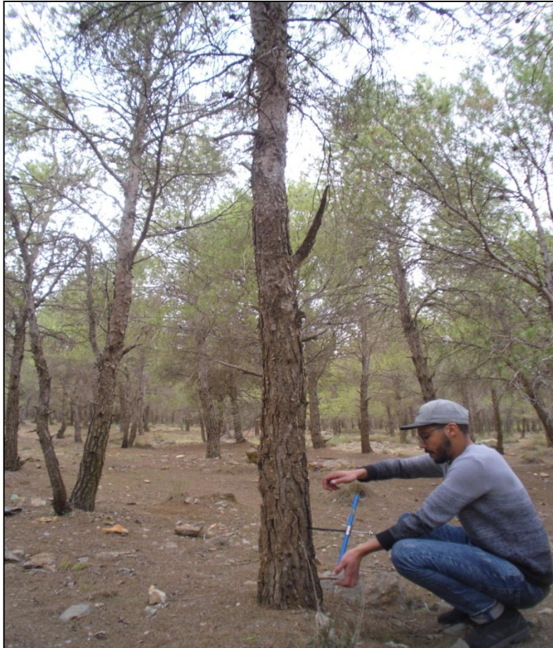
Figure 16 : Sondage à la tarière de PRESSLER, pour l'estimation de l'âge du peuplement
