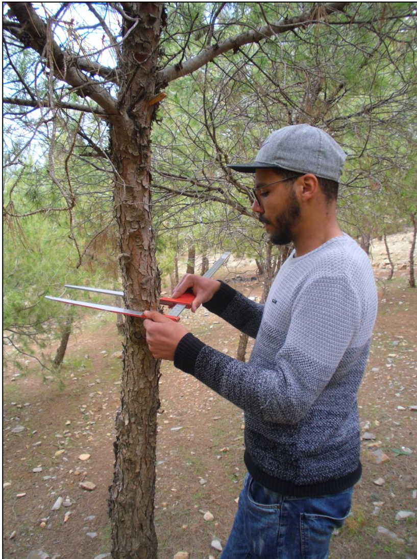
Figure 11: Utilisation du compas forestier dans la mesure du diamètre à 1,30 des arbres de pin d'Alep (FD. Sebdou).
