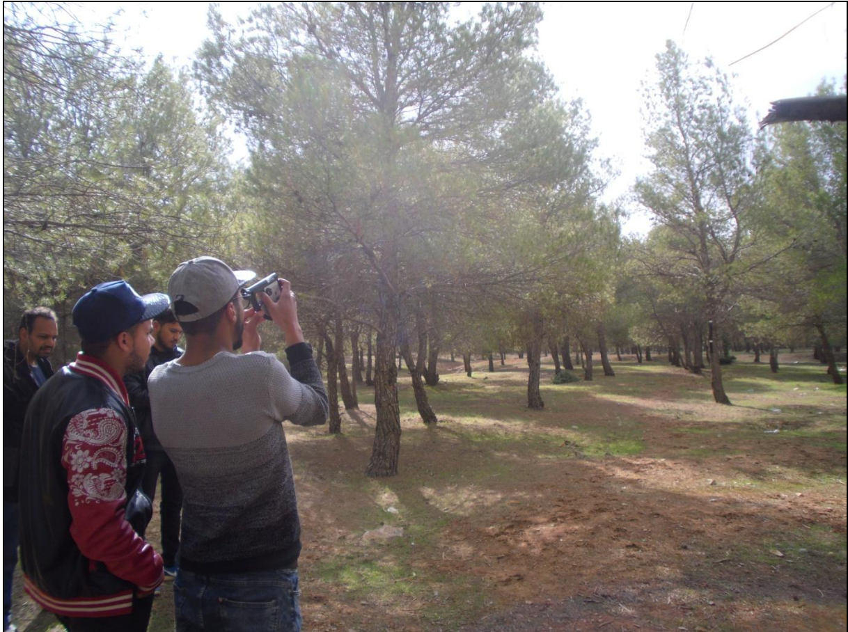
Figure 13: Mesure de la hauteur à l'aide d'un Blume-leiss et une mire pliante fixée sur le tronc d'arbre de pin pignon (Clichés : Fév , 2018)
