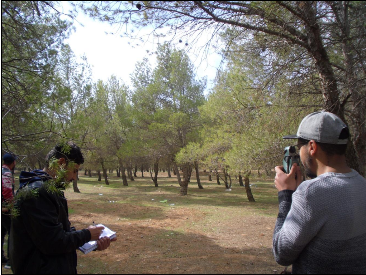
Figure 15 : Mesure du coefficient de forme des arbres sur pied de pin d'Alep à l'aide du Relascope de Bitterlich (FD. Sebdou).
