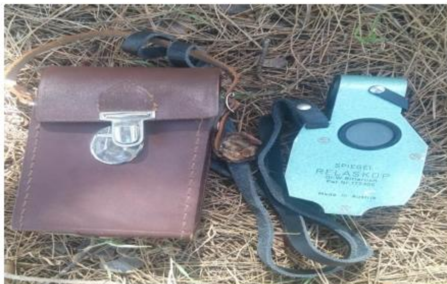
Figure14 : Le Relascope de Bitterlich utilisé pour la mesure du coefficient de forme des arbres de pin d'Alep dans FD. Sebdou.
