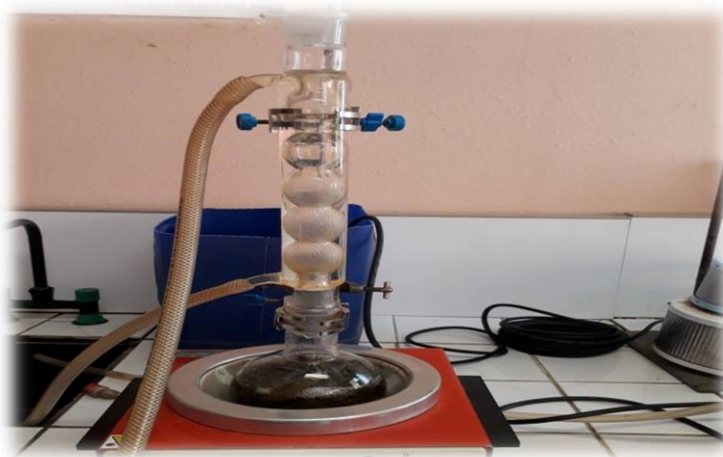
Figure 17 : Montage de reflux.
