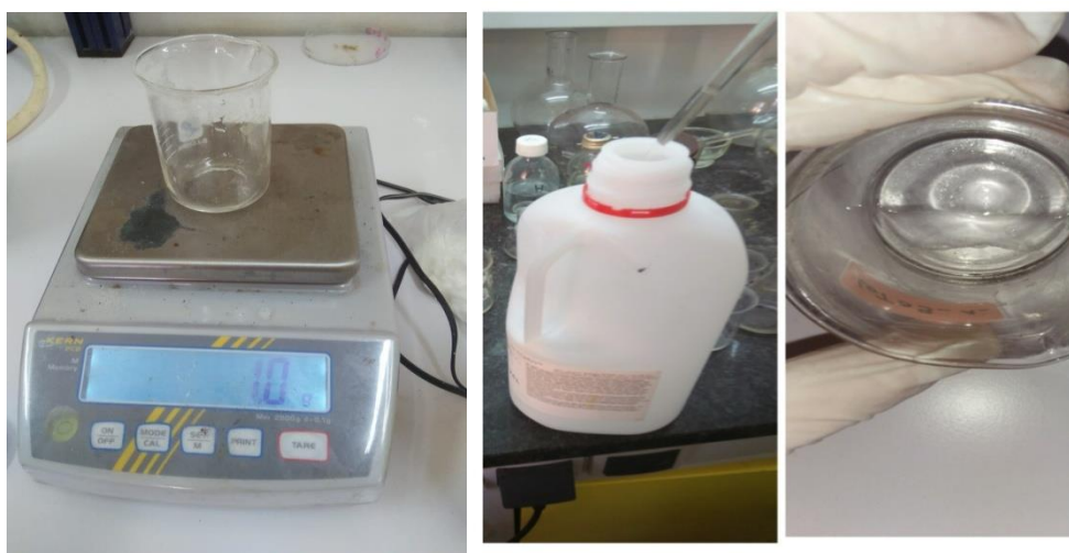
Figure 30 : Pesé de 1 g de corps gras et l'addition de l'éthanol à 96% (photo original).
