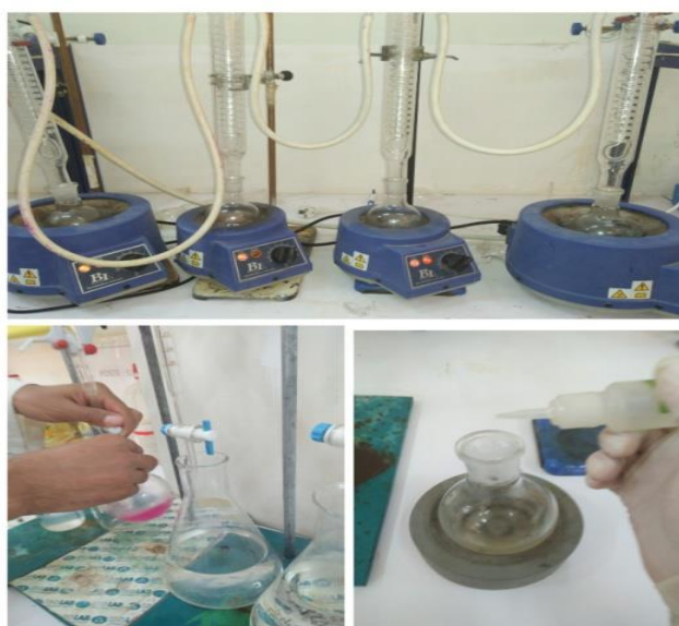
Figure 35: Fioles en chauffe + l'addition des gouttes de phénolphtaléine + le dosage par l'HCL(photo originale).
