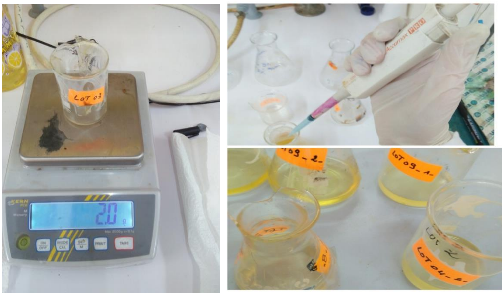
Figure 32: Pesé de 2 g de corps gras puis l'ajout de 10 ml de chloroforme, 15 ml d'acide acétique, puis 1 ml de solution de Ki ( photo originale ).
