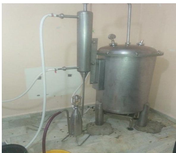
Figure 19 : L'alambic d'hydrodistillation (laboratoire de parc national de Tlemcen) ( photo original ).
