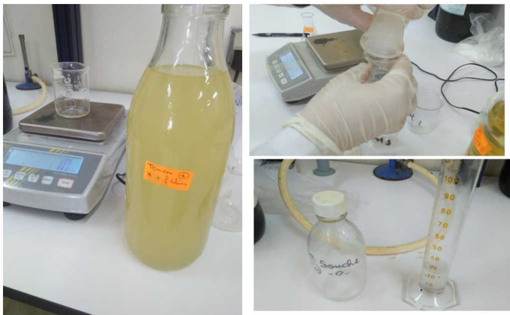
Figure 34 : Pesé de 1 g de corps gras puis l'ajout de 25ml de KOH (photo originale).
