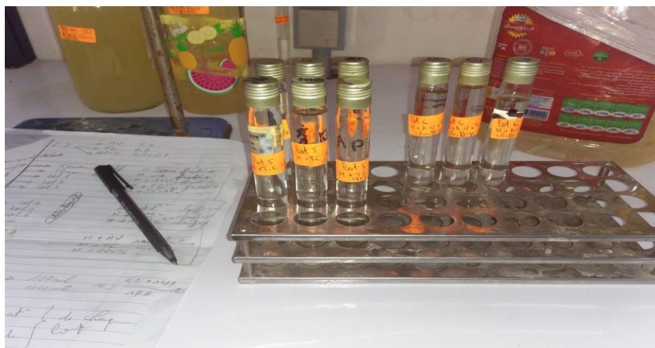
Figure 24 : Tubes à essai rempli par le mélange d'huile de tournesol et huile essentiel (A.V et T.C) pour un chauffage de 180°C ( photo original ).
