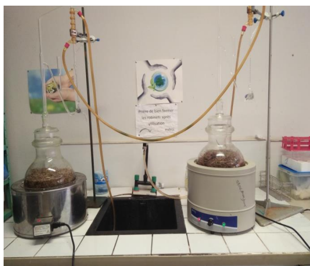
Figure 18 : L'appareil d'hydrodistillation (laboratoire LASNABIO) ( photo original ).
