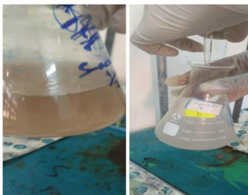
Figure 33 : le titrage d'iode libéré avec la solution de thiosulfate de sodium après l'ajout de l'amidon comme indicateur ( photo originale ).
