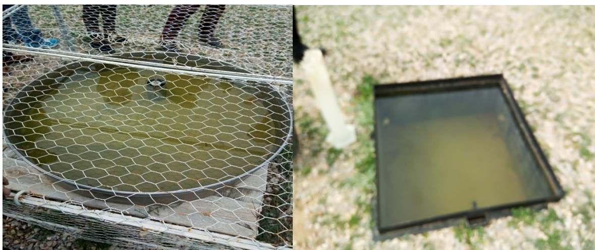
Photo 06 : Bacs d'évaporation Classe « A » et Colorado (Benahmed ,2018).
