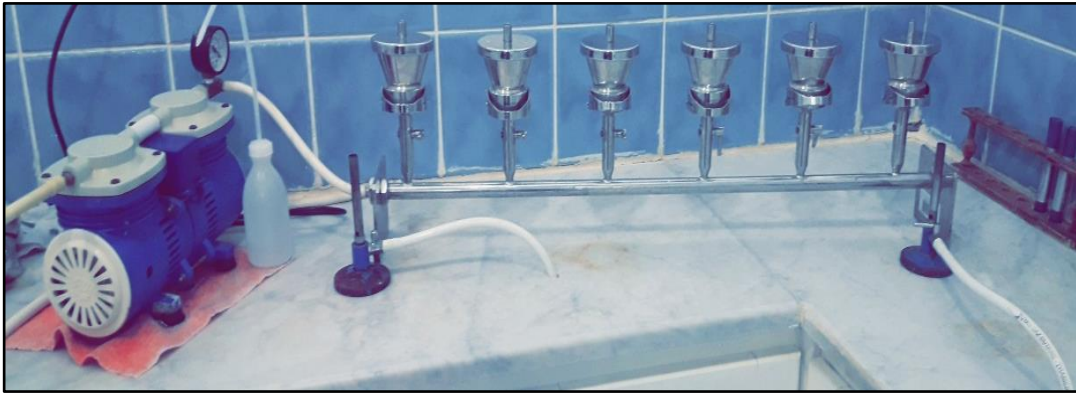
Fig. 47 : La rampe de filtration (Photo prise par M lle . F. BOUALI & M lle . A. BRAHIM au niveau du laboratoire de la station de traitement du Sekkak, le : 27/05/2021).
