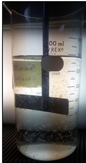
Fig.28 : Formation des flocons (Photo prise par M lle . F. BOUALI & M lle . A. BRAHIM au niveau de la station de traitement Sekkak, Tlemcen, le : 04/04/2021).
