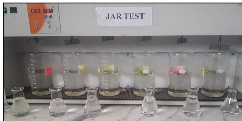
Fig.29 : Le jar-test (Photo prise par M lle . F. BOUALI & M lle . A. BRAHIM au niveau de la station de traitement Sekkak, Tlemcen, le : 04/04/2021).
