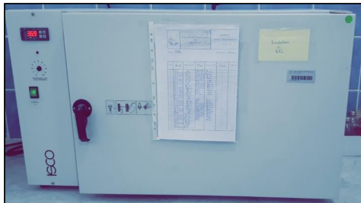
Fig. 49 : Incubateur à 37°C (Photo prise par M lle . F. BOUALI & M lle . A. BRAHIM au niveau du laboratoire de la station de traitement du Sekkak, le : 27/05/2021).
