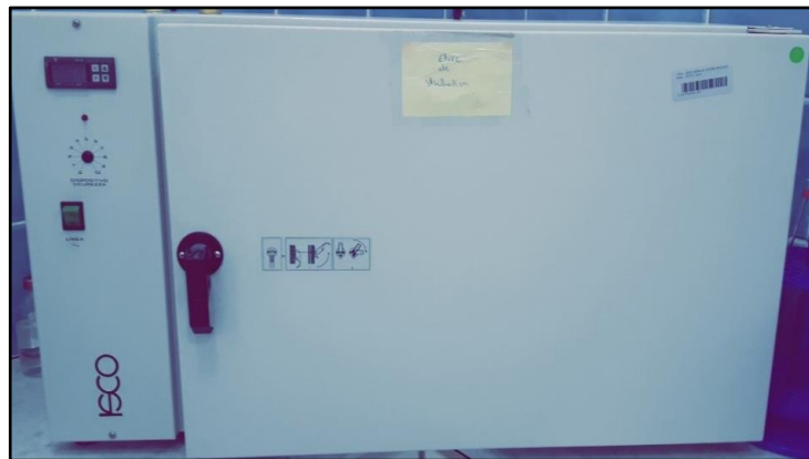
Fig. 48 : Etuve de stérilisation (Photo prise par M lle . F. BOUALI & M lle . A. BRAHIM au niveau du laboratoire de la station de traitement du Sekkak, le : 27/05/2021).
