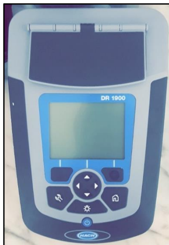
Fig. 43 : Spectrophotomètre HACH DR 1900 (Photo prise par M lle . F. BOUALI & M lle . A. BRAHIM au niveau du laboratoire de la station de traitement du Sekkak, le : 27/05/2021).
