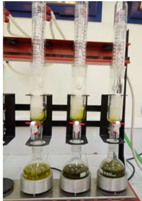
Figure 15: Montage d'extraction par l'appareil de Soxhlet
