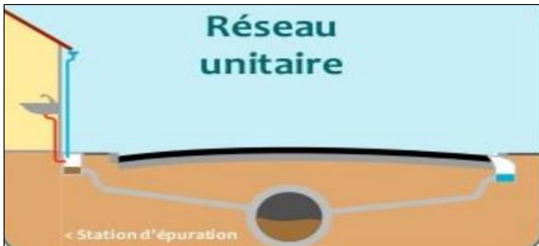
Figure 6: Schéma d'un réseau d'assainissement collectif [17].
