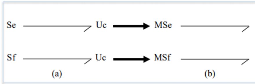
FIGURE 2.4: éléments actifs : a-source d'effort et de flux , b- sources
