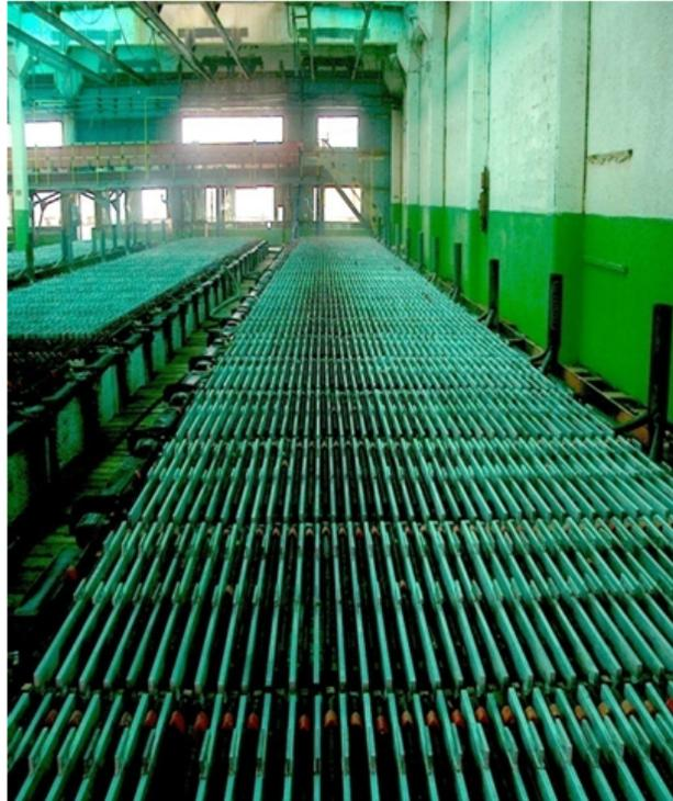
FIGURE 1.5 – Atelier d'électrolyse de zinc. [11]
