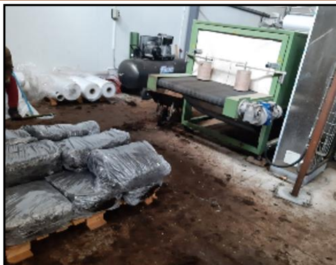
Figure 25: La machine de l'ensemencement de mycélium dans le compost (MEDJDOUB Djilali ; 2021)
