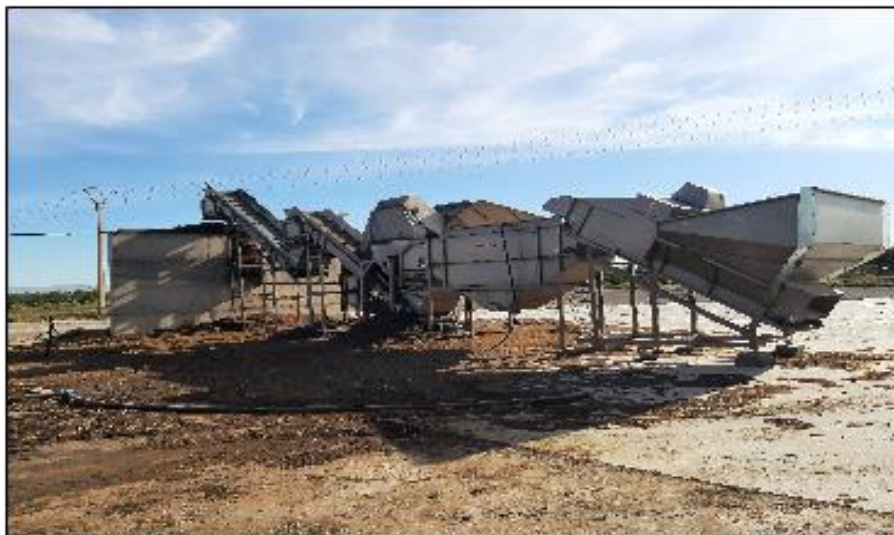
Figure 18. La chaine des machine qui mélanger et homogénéiser les composants de composte (MEDJDOUB Djilali ; 2021)
