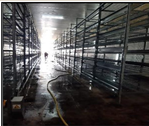
Figure 26: La stérilisation de la chambre de production avant l'incubation (MEDJDOUB Djilali ; 2021)
