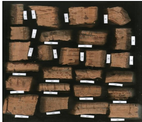
Planche 13 : Polissage des échantillons de liège leur numérisation par un scanner(Khobzaoui,2021)
