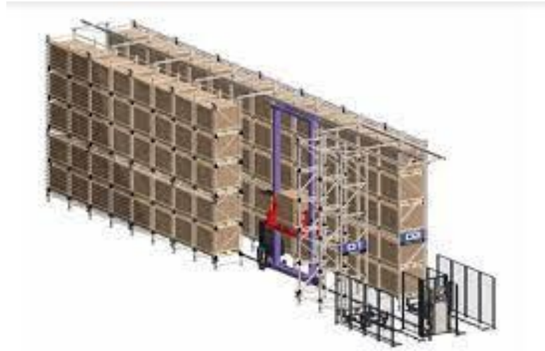
Figure I.5 AS/RS à charge unitaire [8]
