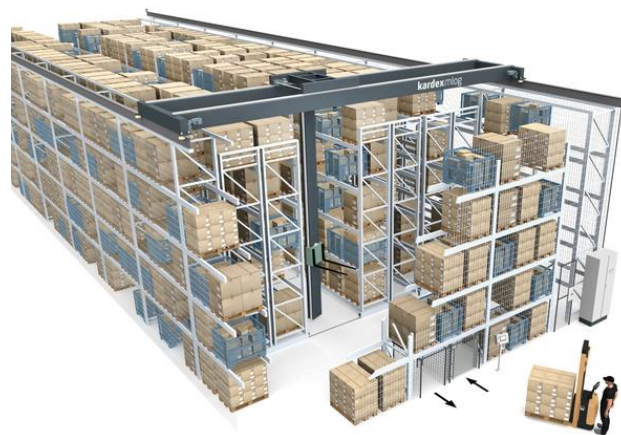
Figure I.17 : AS/RS à racks glissants [15]
