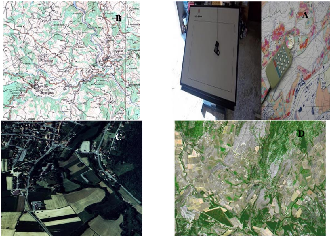
Figure 8 : Exemples de données utilisées dans le SIG : (A) Numérisation ; (B) Balayage électronique ; (C) Photogrammétrie ; (D) Télédétection.
