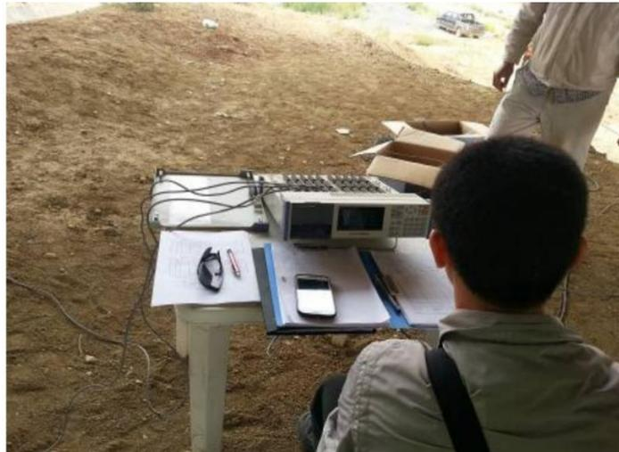
**Figure3- 7-Le système d'acquisition avec les Fleximètres**
