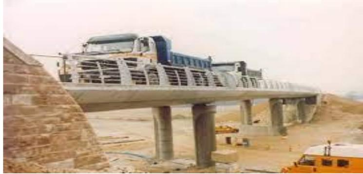
**Figure1- 3-Chargement d'appui d'une dalle**
