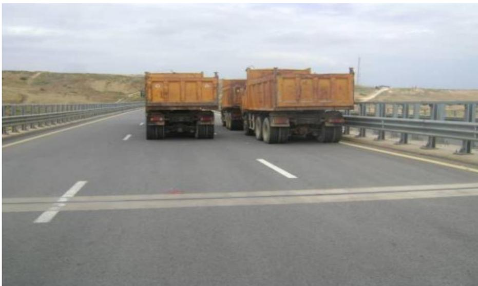
**Figure3- 13-1er cad de chargement(rive)**
