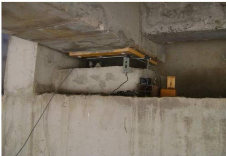
**Figure3- 8-Les Fleximètres installés au droit des appareils**
