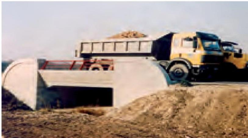
**Figure1- 6-Essai de chargement d'un ouvrage de faible portée**
