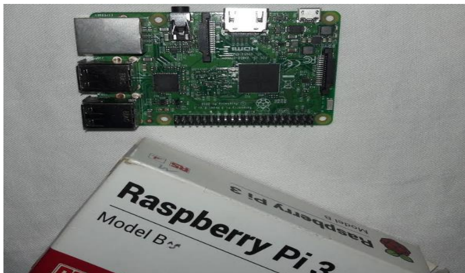
Figure II.14. Raspberry Pi Modèle 3 B utilisé dans notre projet
