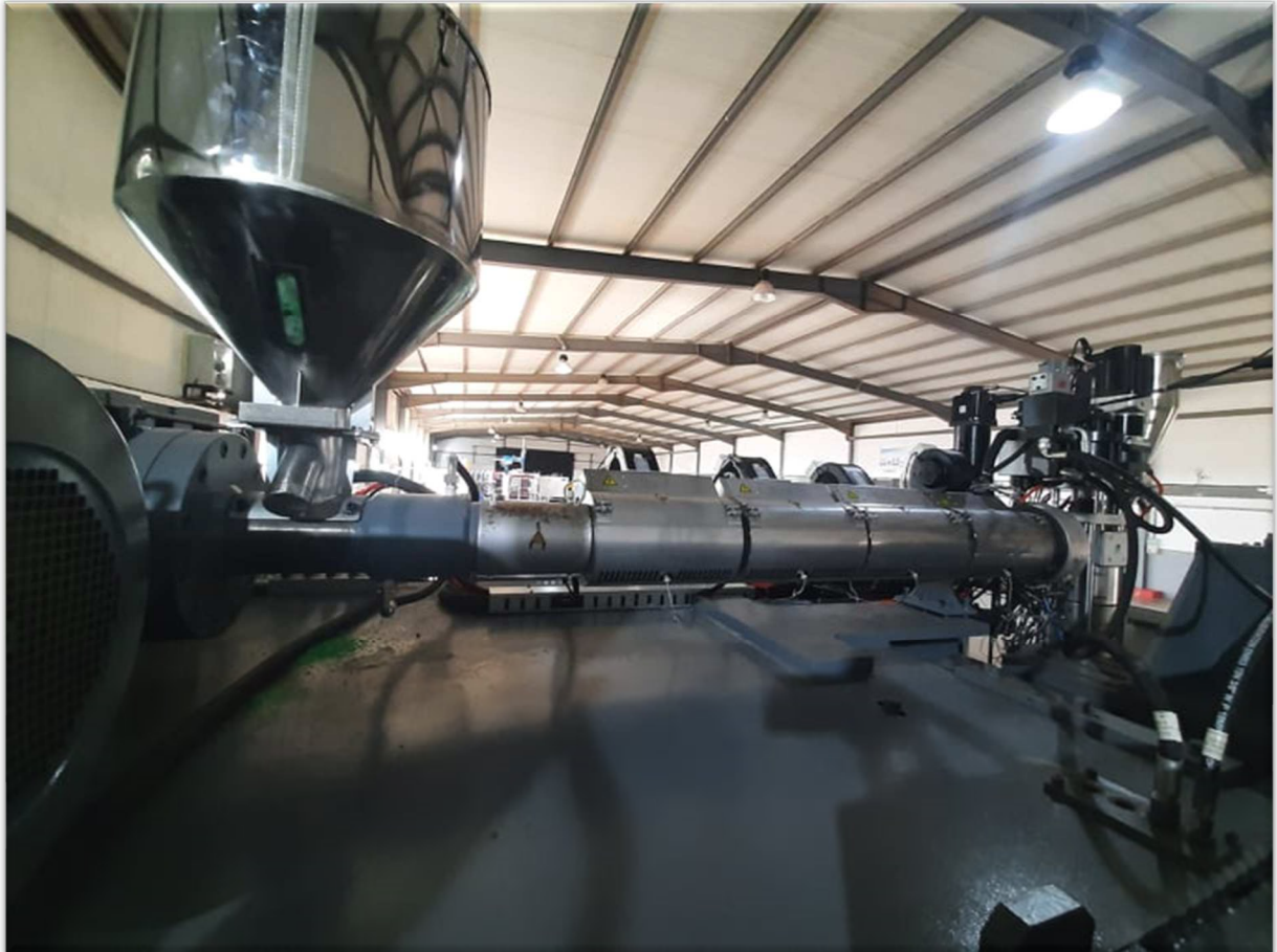
Figure I. 12 : Photo réelle du Dépôt et chauffage de la matière première dans la vis
