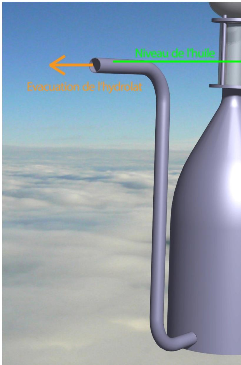
Figure 3.28 Conception du tuyau de sortie de l'essencier
