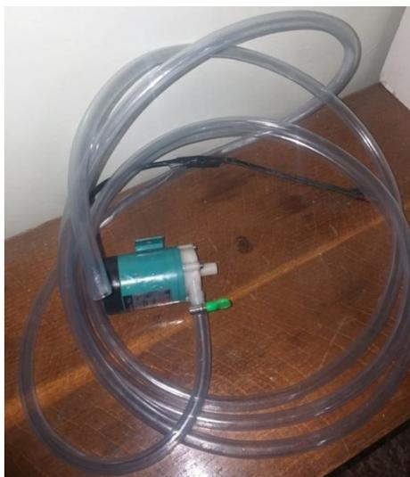
**Figure 4.28** Tuyau en plastique d'entrée/sortie de réservoir de condensation
