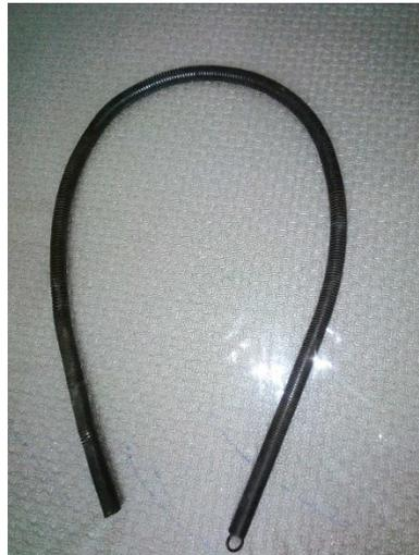
**Figure 4.22 Ressort à cintrer pour tube en cuivre**
