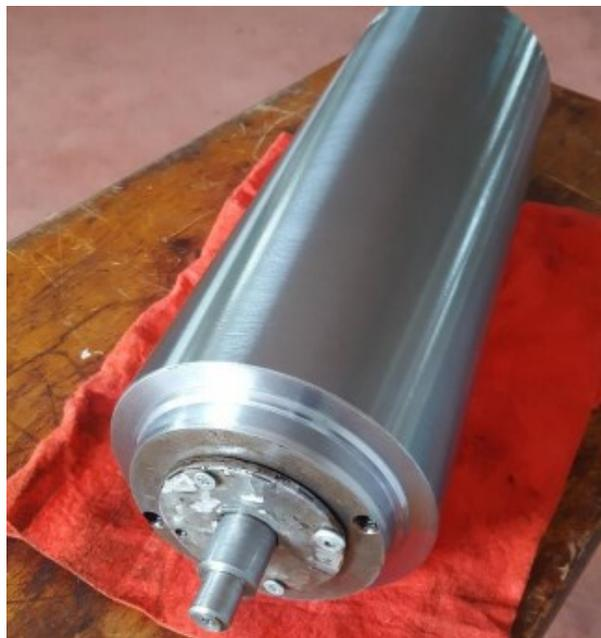
**Figure 4.21 Le Moule utilisé pour cintrer le tube en cuivre**
