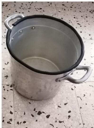
**Figure 4.2 Cuve avec joint en Silicon**
