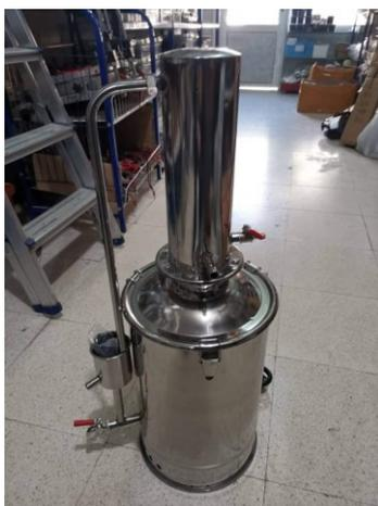
**Figure 1.21 Distillateur par entrainement à la vapeur d'eau (50L)**
