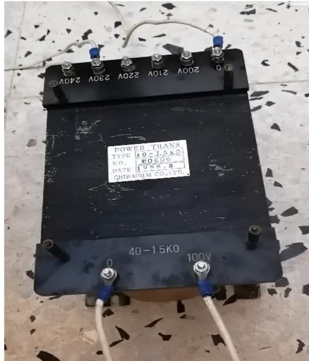
**Figure 4.31 Transformateur de tension**
