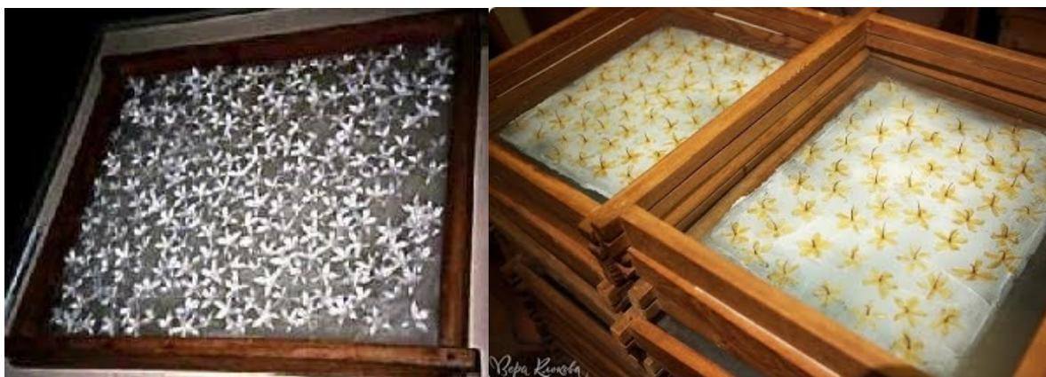
Figure 1.14 Enfleurage à froid sur des châssis en bois [18]
