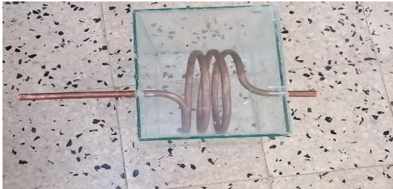
**Figure 4.27** La réalisation du réservoir de condensation avec le serpentin
