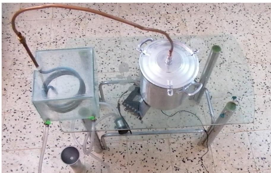
**Figure 4.35 Réalisation du prototype du distillateur**
