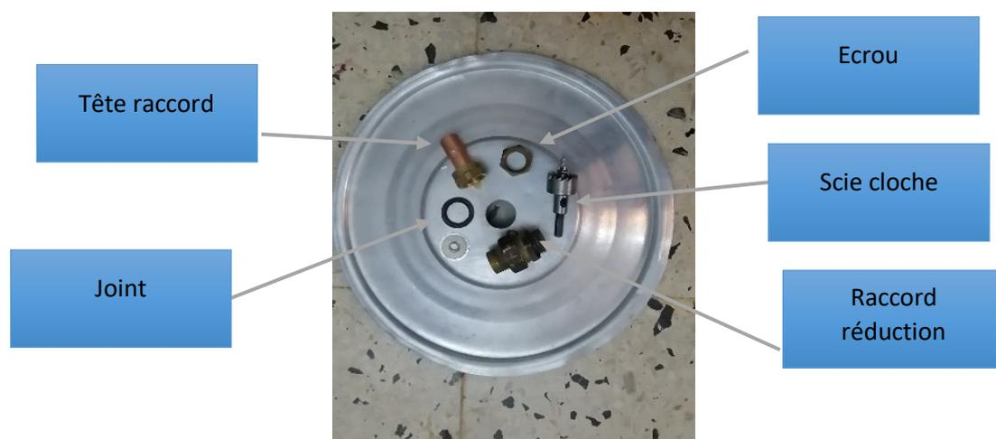
**Figure 4.6 Couvercle de la cuve après le traitement**
