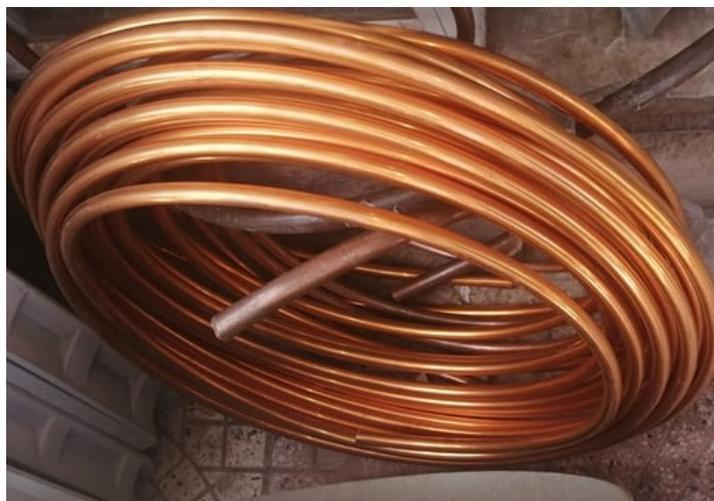
**Figure 4.19** Tube en cuivre de diamètre 14mm
