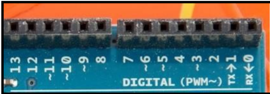
Figure II.4 Broches numériques de la carte Arduino UNO [29]
