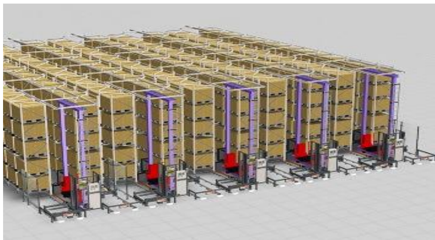
Figure 1. 7 AS/RS à charge unitaire prise du site de l'entreprise daifuku-logisticssolutions
