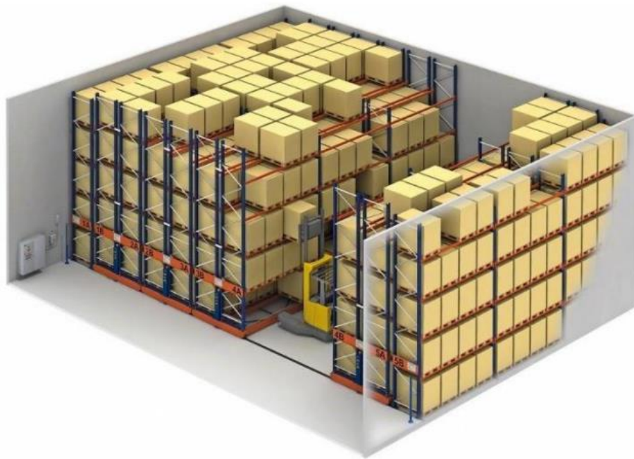
Figure 1. 9 Vue générale d'un AS/RS à racks glissants
