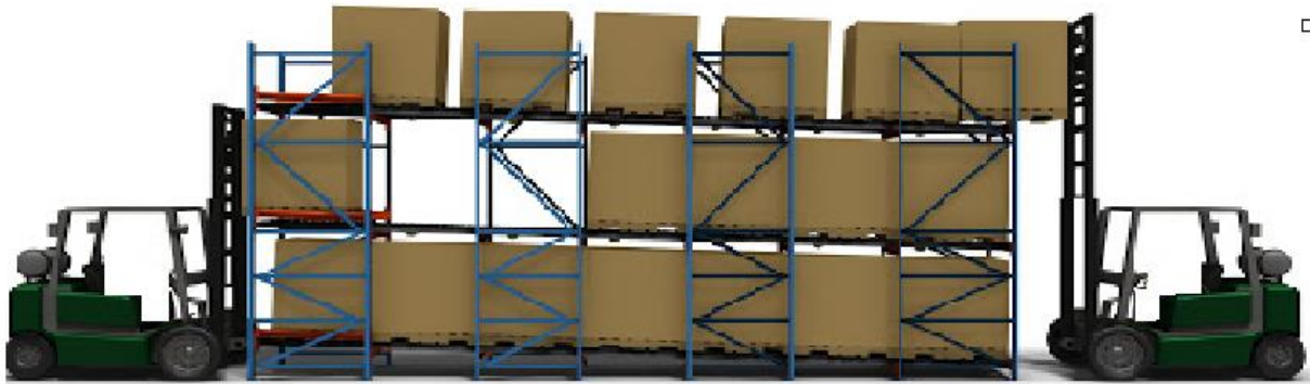
Figure 1. 12 L'AS/RS à convoyeurs gravitationnels forme de base vue de côté
