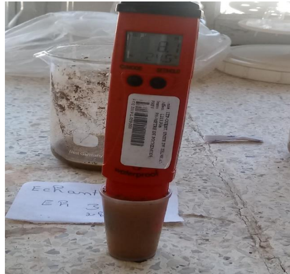
Figure 26 Photo originale : mesure du Ph d'un échantillon avec le pH-mètre de POCHEMODE
