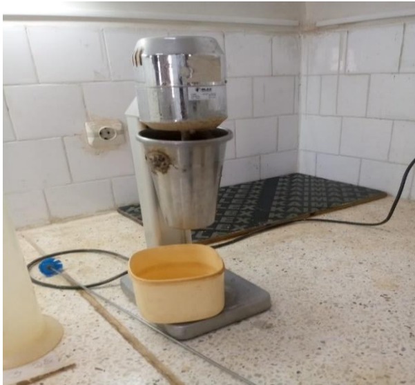
Figure 32 Photo originale : échantillon passant à l'agitateur électrique
