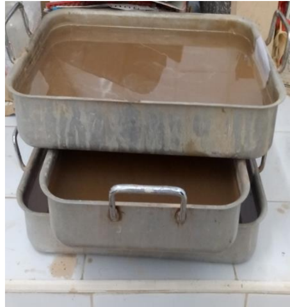
Figure 30 Photo originale : tamisât destiné à la sédimentométrie entrain de décanter
