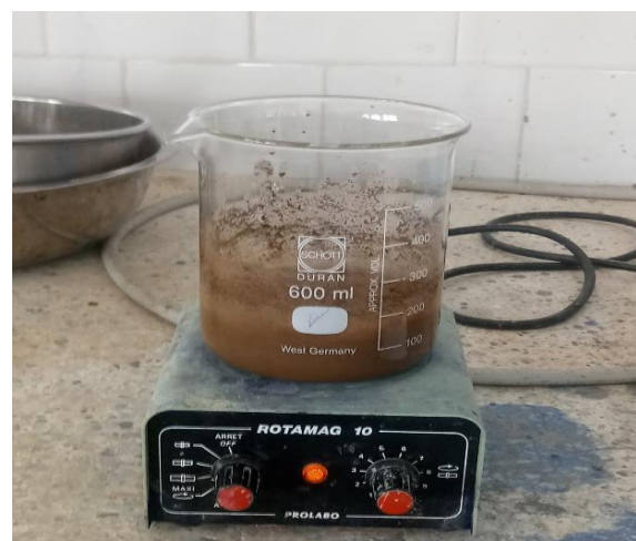
Figure 25 Photo originale : un échantillon agité à l'aide d'un agitateur mécanique
