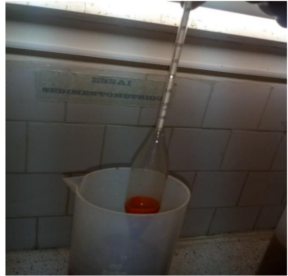
Figure 33 Photo originale d'un densimètre permettant de relever les mesures
