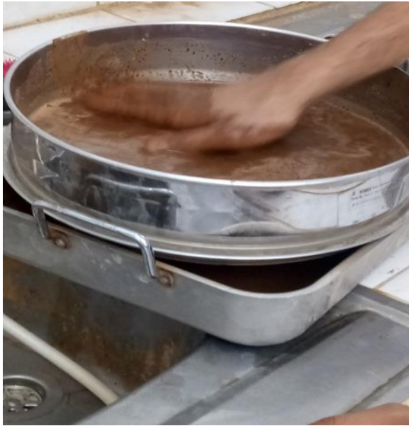
Figure 31 Photo originale : échantillon imbibé passant au tamis 80 \mu\text{m}
