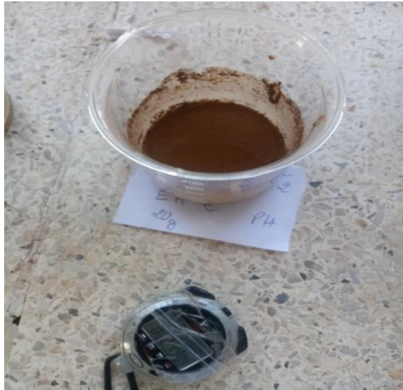
Figure 27 Photo originale : un échantillon en décantation
