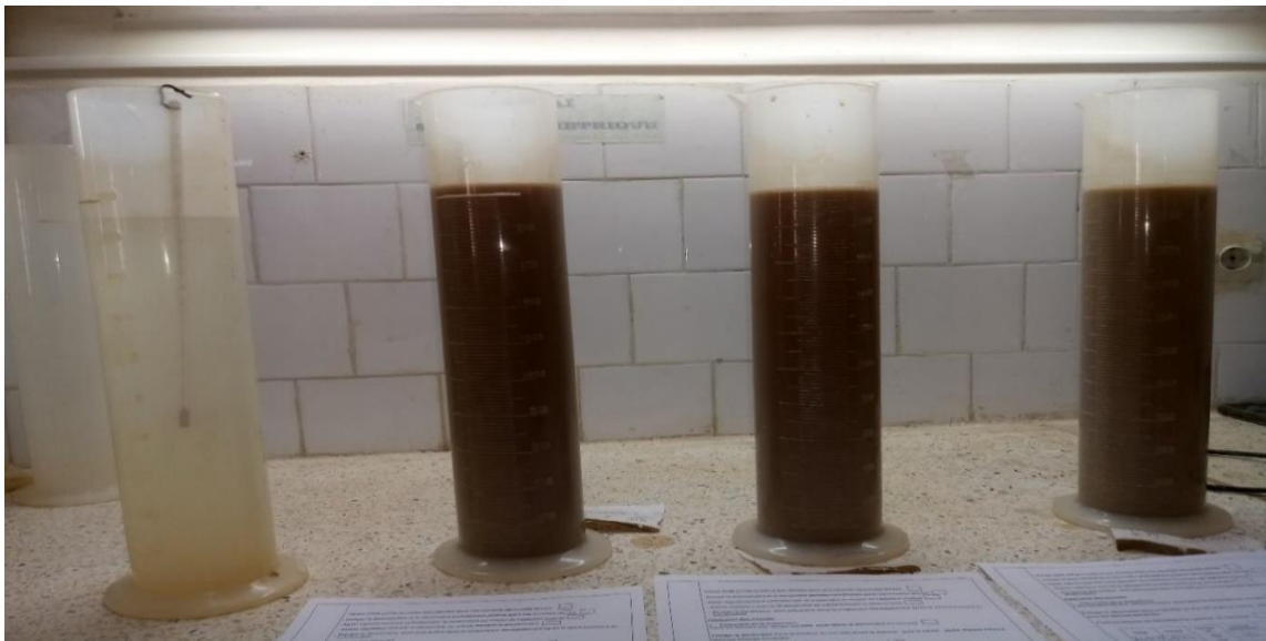
Figure 34 Photo originale : échantillons dans des éprouvettes complété à 200 ml avec de l'eau distillée
