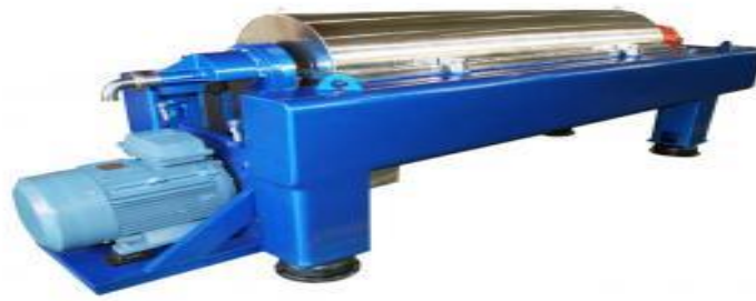
Figure 2-14: Décanteur centrifugé pour l'huile d'olive (35) .
