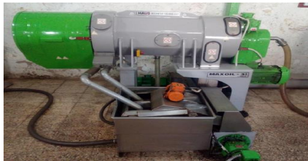
Figure 2-16: Le décanteur du système à 3 phases (DEBBAL, 2017).
