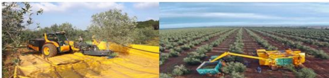
Figure 2-4: Récolte d'olive par récolteuses (machine) (29).
