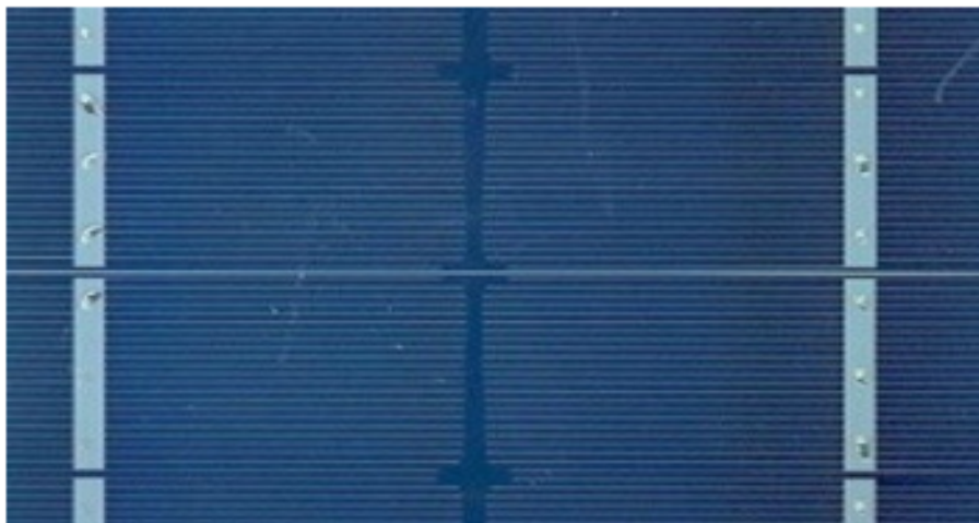
Figure I.4: cellule en silicium monocristallin [9].
