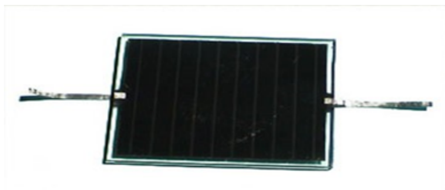
Figure I.6: cellule en silicium amorphe [9].
