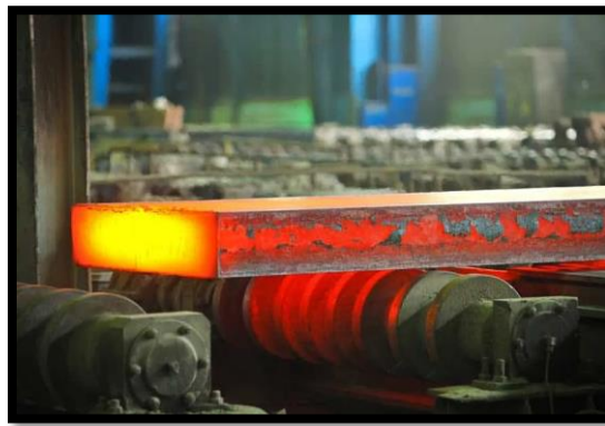
Fig I.4. L'acier laminé à chaud est idéal pour les produits où des tolérances rigoureuses ne sont pas requises. (6)
