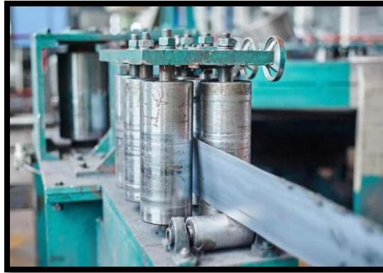
Fig I.5. L'acier laminé à froid est idéal pour les produits demandant des dimensions exactes et des caractéristiques de surface améliorées. (6)
