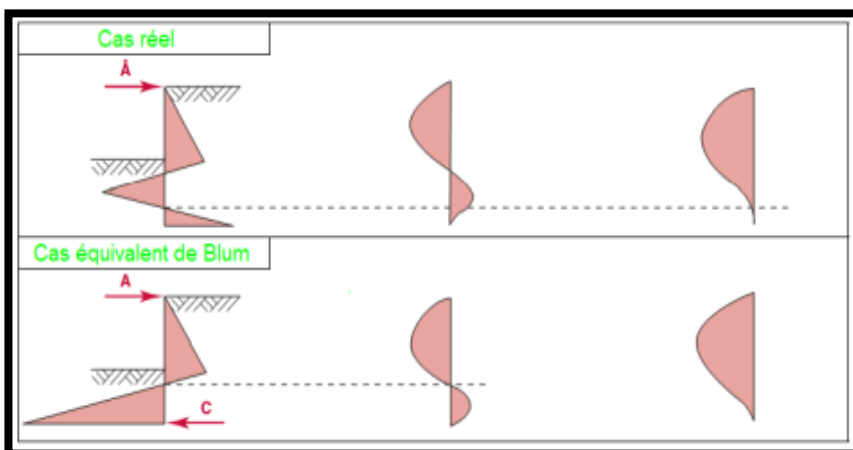
Fig I.63. Distribution idéalisée de la pression des terres. (4)
