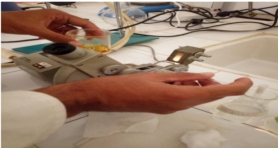
Photo10 -Mesure d'indice de réfraction par un réfractomètre (BENAMAR, 2021)
