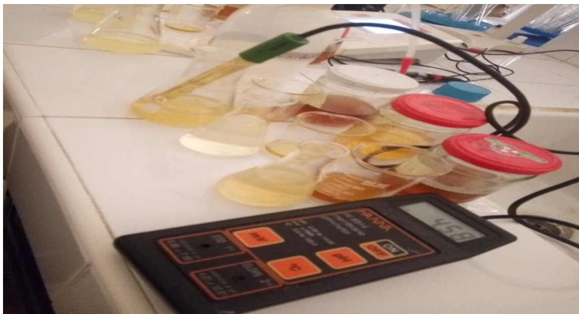
Photo 11- Mesure de pH avec un pH-mètre (BENAMAR, 2021)
