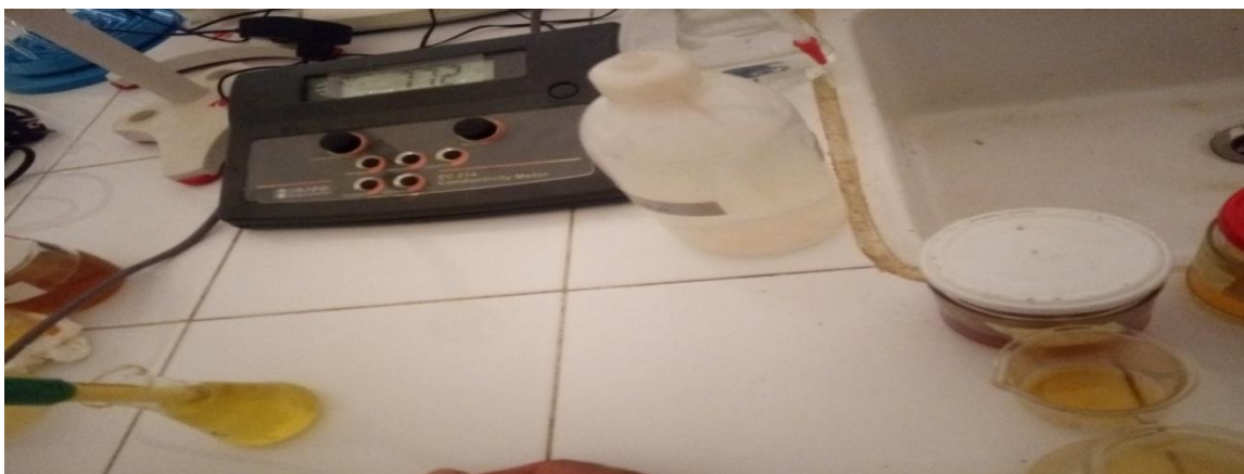
Photo 14- Mesure de la conductivité électrique par un Conductimètre (BENAMAR, 2021).
