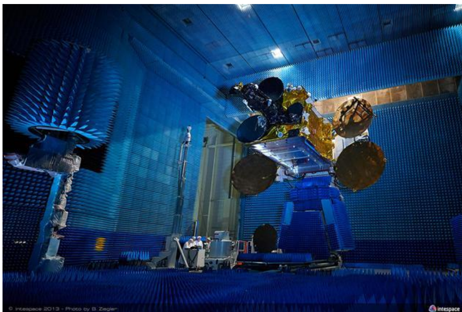
Figure 1. 29 : Essais RF-CEM (Compatibilité-Electro-Magnétique).
