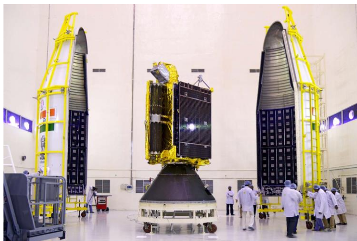
Figure 1. 20 Volume sous la coiffe du lanceur
