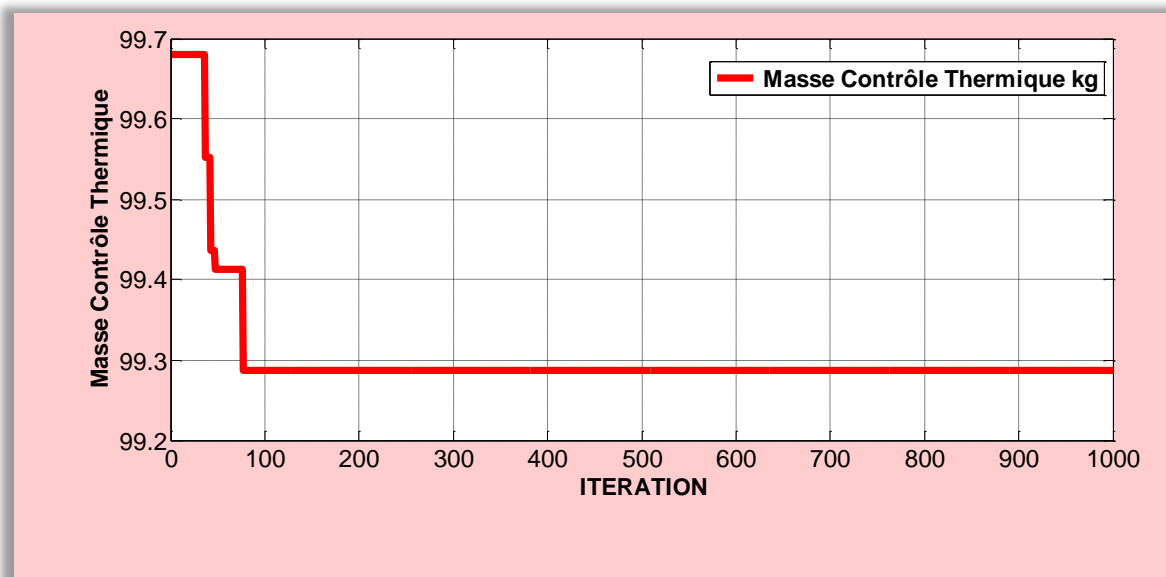
Figure 4. 45 : Evolution de la masse du sous-système contrôle thermique durant le processus MDO
