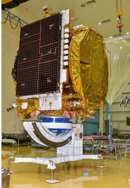
Figure 1. 30 : Tests inertiel du satellite INSAT-4A.
