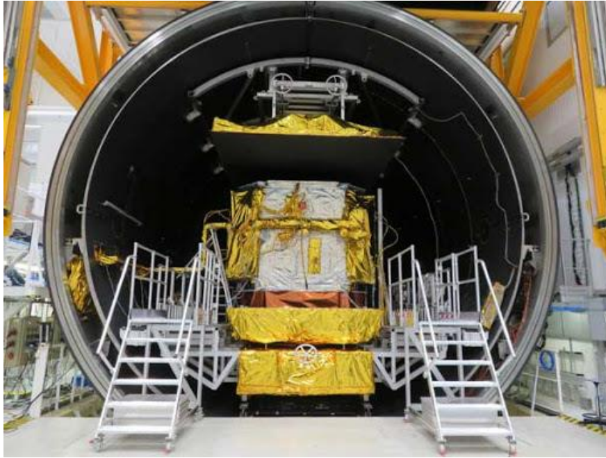
Figure 1. 26 : Essais du vide thermique.
