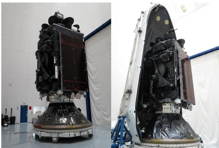
Figure 1. 17 Adaptateur conique du satellite Inmarsat série 5 prêt pour le lancement [17]
