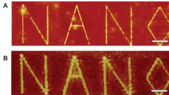
Figure I.29 : (a) Image produite avec une super lentille (b) Image produite lentille ordinaire [42].
