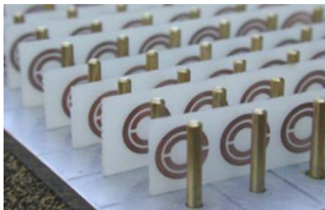
Figure I.9 : La structure proposée par D. Smith qui combine les fils minces et les SRR pour avoir un milieu doublement négatif (métamatériaux) [2].
