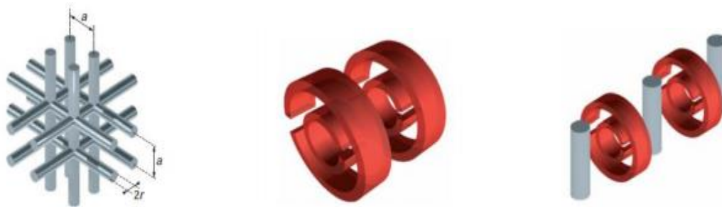
(a) réseau de fils métalliques cylindriques. (b) réseau de résonateurs circulaires coupés. (c) association des deux réseaux précédents.
