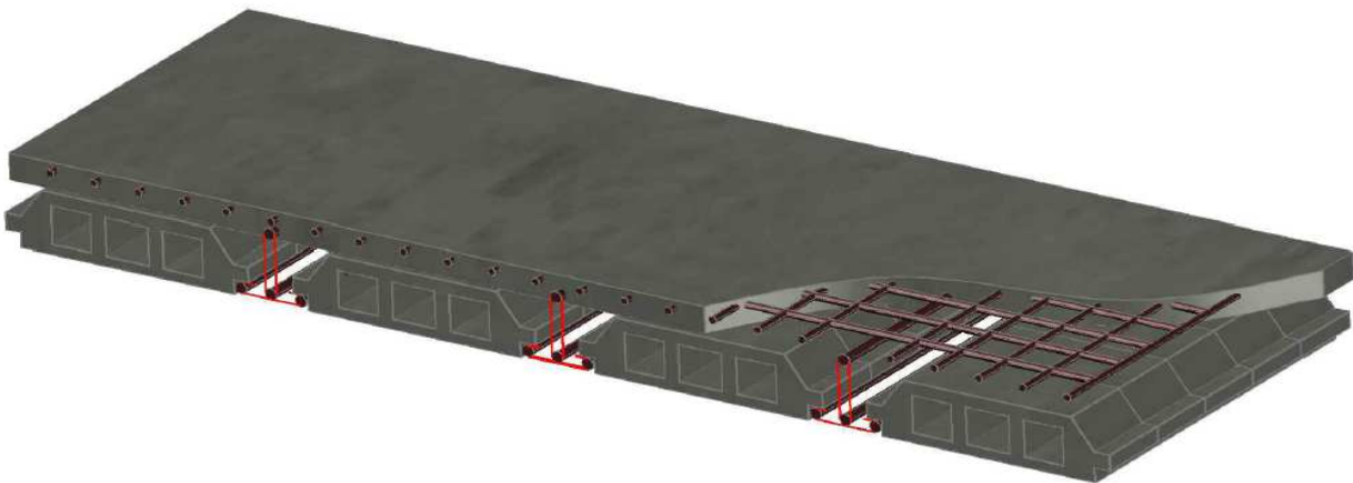
Figure 2. 7: Illustration en 3D d'un plancher à entrevous.
