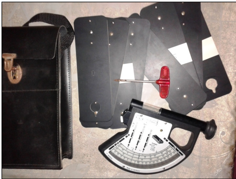
Fig. 37 : Photo du dendromètre BLUME-LEISS utilisé dans la mesure des arbres dans le cas de notre inventaire typologique.
