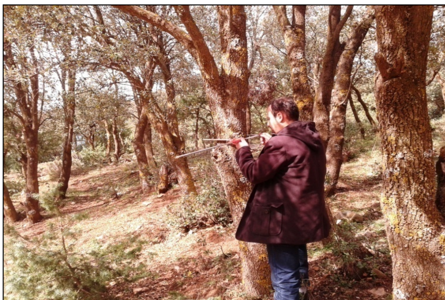
Fig. 34 : Mesure de diamètre des arbres de chêne vert à l'aide d'un compas forestier (Cliché : BENABDALLAH, 2018)
