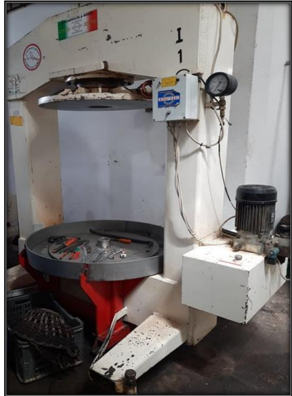
Photo 15 : Presse hydraulique semi-moderne (Huilerie Hakiki)
