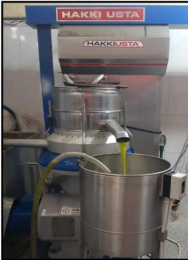
Photo 25 : Centrifugeuse verticale (Huilerie d'Ouzidane)
