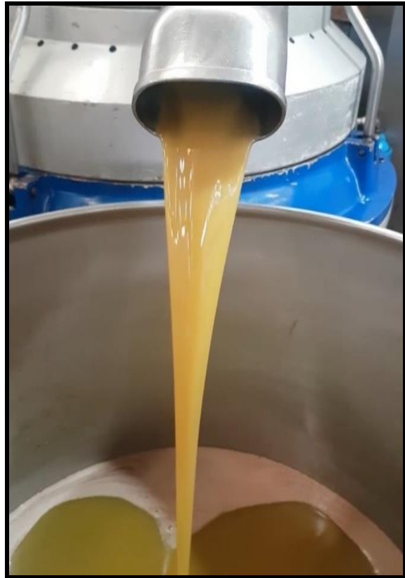
Photo 26 : l'huile à la sortie du séparateur centrifuge (Huilerie d'Ouzidane )
