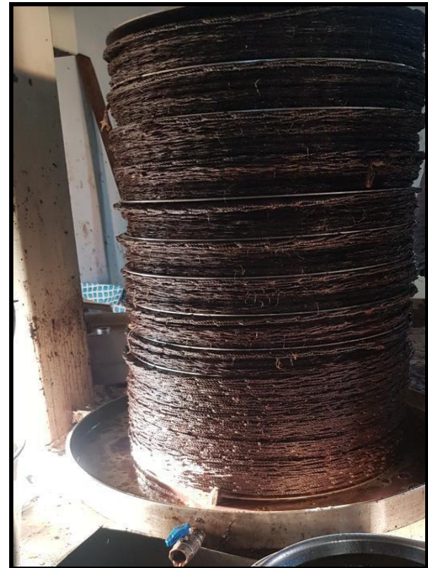
Photo 13: Presse hydraulique traditionnelle (Huilerie Benisnous)
