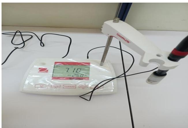
**Figures 14 :** pH-mètre pour mesurer l'acidité des liquides
