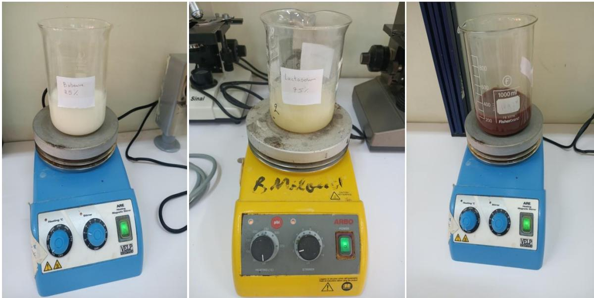
Figure 16 : Agitateurs de laboratoires
