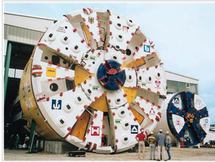
Figure 1.11 Exemple de tunneliers (Hambourg 14.2 m, Berlin 8.9 m) Toan (2007)
