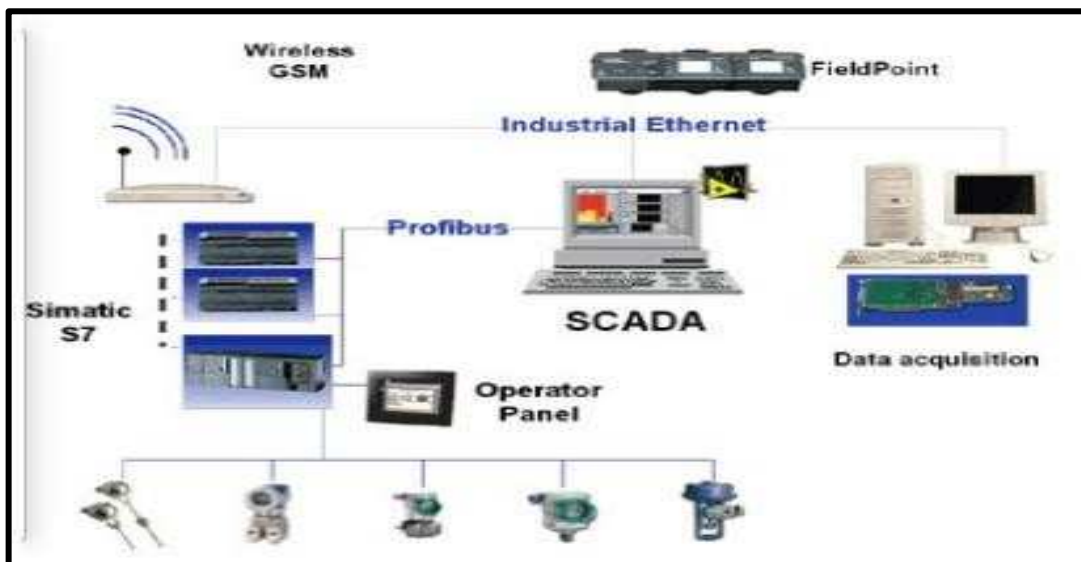
Figure I. 11 : Combinaison des outils softs et hard des systèmes SCADA. [7]
