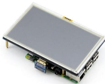
Figure IV. 8 Montage de l'écran LCD avec la carte Raspberry.
