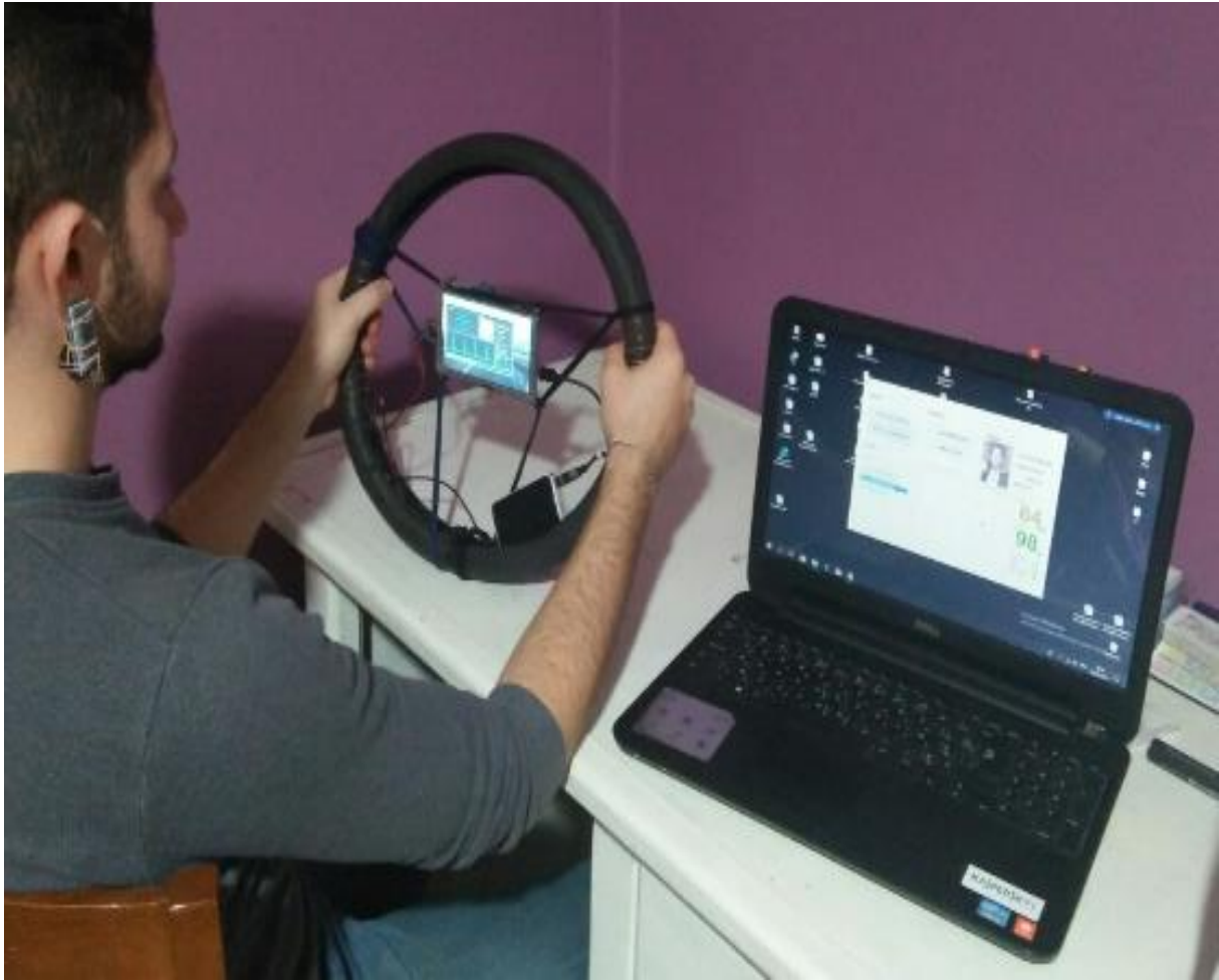
Figure IV. 13 la station de télésurveillance et la station de télé-vigilance.
