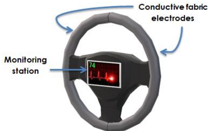
Figure IV. 10 Emplacement des électrodes et de la station de surveillance.
