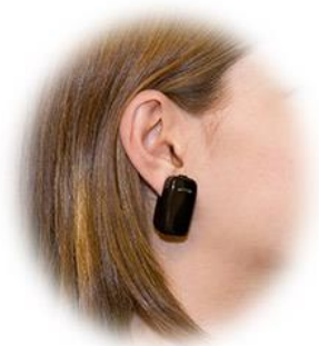
Figure IV. 11 Capteur PPG sans fil fixé au lobe d'oreille.
