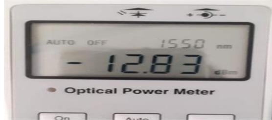
**Fig.3. 30.** Puissance de sortie du deuxième port d'un diviseur optique
