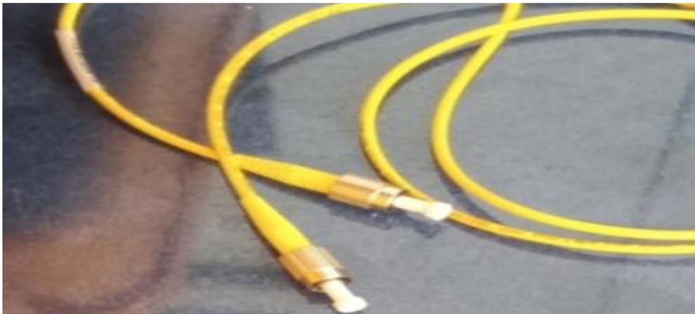
**Fig.3. 2.** Fibre optique monomode P1-SMF-28-FC-1 du fabricant Thorlabs
