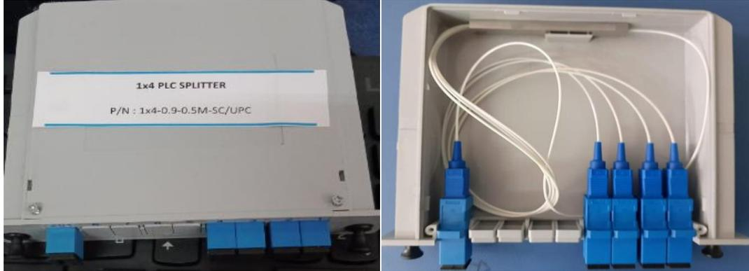
**Fig.3. 26.** Un diviseur optique à une entrée et 4 sorties
