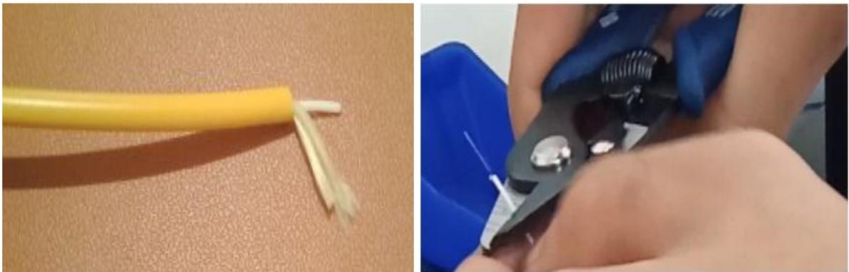
**Fig.3. 10.** Dénudage de fibre optique monomode de 3mm
