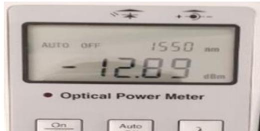
**Fig.3. 31.** Puissance de sortie du troisième port d'un diviseur optique
