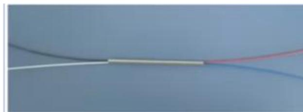
Fig.2. 18. Schéma du coupleur directionnel
