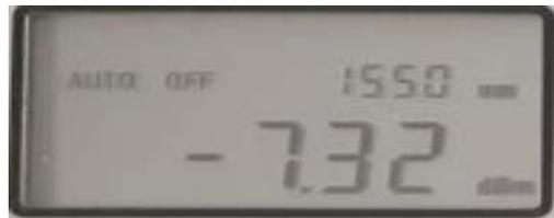
**Fig.3. 9.** Puissance reçue sur le wattmètre optique
