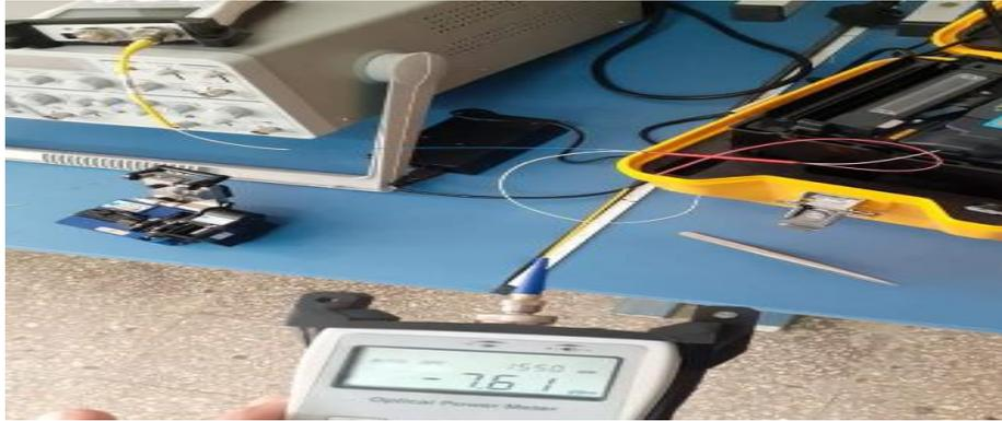
Fig.3. 22. Méthode expérimentale de mesure de pertes
