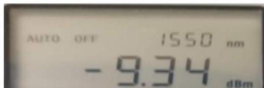
**Fig.3. 19.** Puissance de sortie du port bleu d'un coupleur optique
