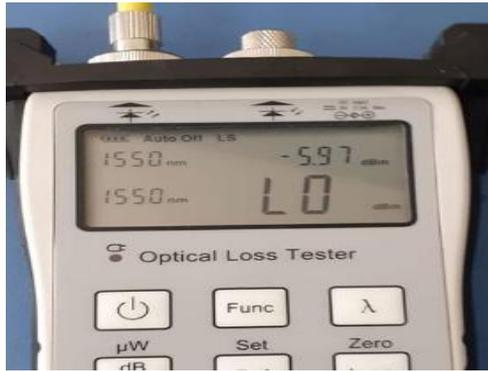
**Fig.3. 28.** Puissance d'entrée du premier port d'un diviseur optique
