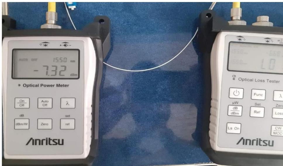
**Fig.3. 7.** Méthode expérimentale de mesure de pertes d'insertion optiques
