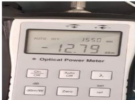
**Fig.3. 29.** Puissance de sortie du premier port d'un diviseur optique
