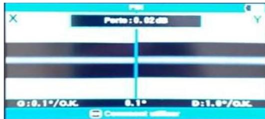
Fig.3. 25. Perte de soudure
