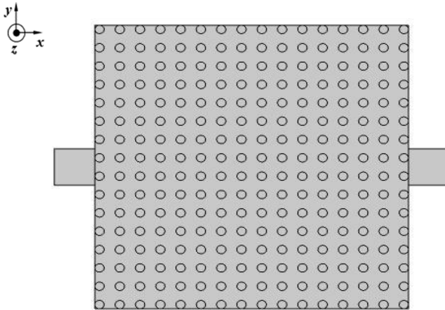
Figure III.20 : Structure déconnectée sans défaut.
