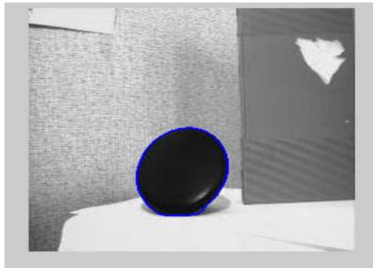
Figure 26: Détection de contour par Fuzzy C-means.
