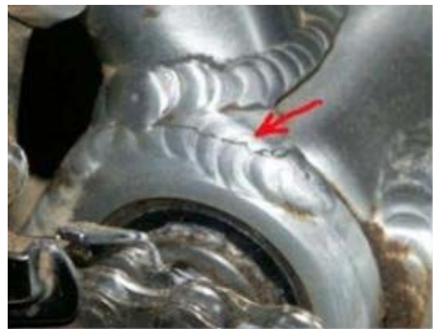
Figure 2-2 : Exemple de fissure sur aluminium. [9]
