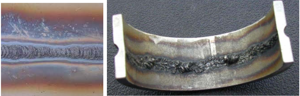
Figure 2-17 : Exemples de défauts de rochage [9]
