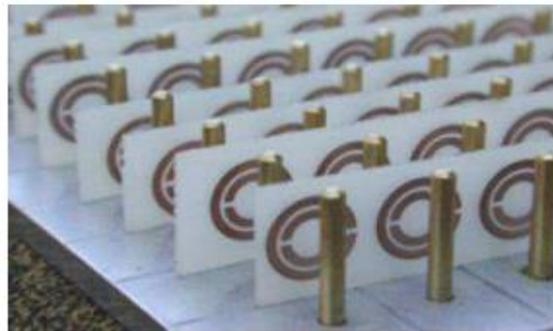
**Figure (2.6) : La structure proposée par D. Smith qui combine les fils minces et les SRR pour avoir un milieu doublement négatif (métamatériaux). [3]**
