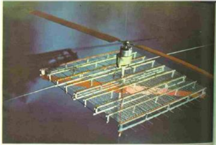
Figure II- 1: Hélicoptère alimenté par de l'énergie microonde [5]
