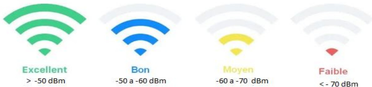
Figure II- 10: Puissance du signale WiFi [15]
