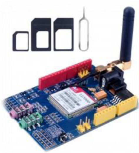
Figure 30 : les photos de module GSM
