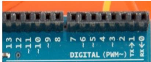
Figure 15 : Les broches numériques (digitales)
