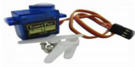
Figure 37 : les fils de servomoteur (alimentation, masse et l'entrée du signal)
