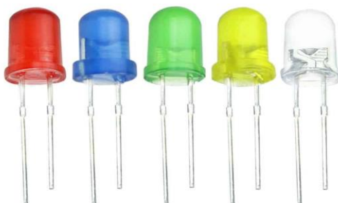
Figure 43 : LEDs de différentes couleurs et le symbole de la diode électroluminescente
