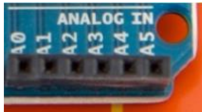
Figure 16 : Les broches analogiques.
