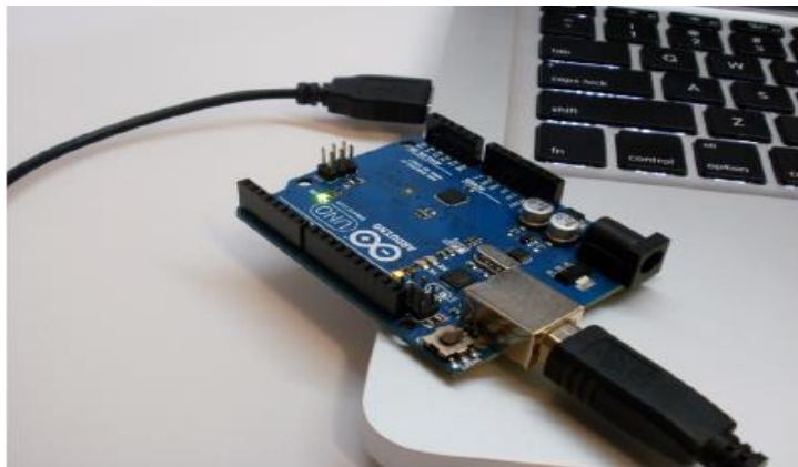
Figure 17 : Le branchement de la carte Arduino avec l'ordinateur via un câble USB.
