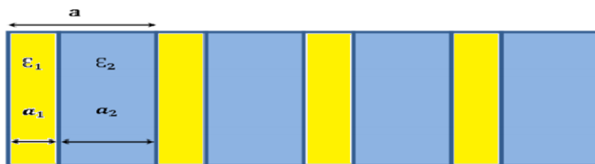
Figure I.9 : Les périodes d'un cristal photonique unidimensionnel.
