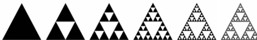
Figure I.16. Structure des antennes fractal triangulaires
