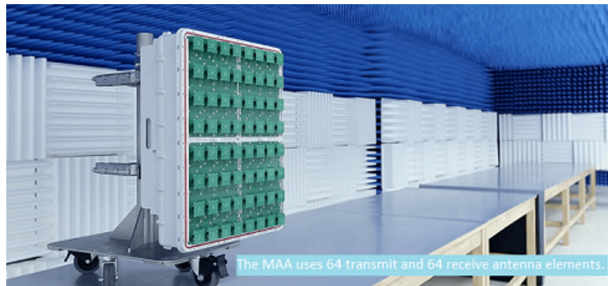
FIGURE 3.7 – Une antenne 64 émetteurs/récepteurs massive MIMO de Nokia
