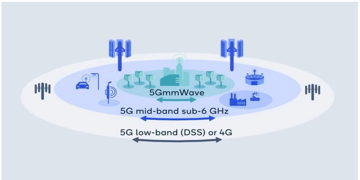
FIGURE 1.2 – Les trois groupes de fréquences utilisés par la 5G [2]
