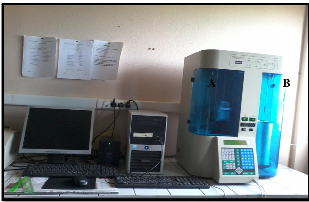
**Figure II.12:** L'appareil NOVA 1000e utilisé pour les mesures BET.
