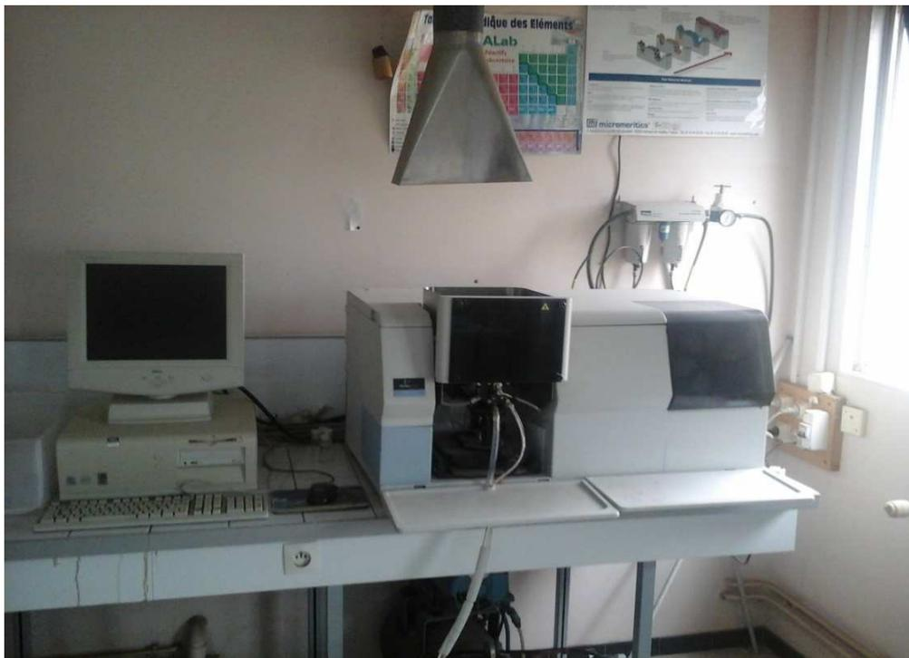
**Figure II.1 :** Appareil de l'absorption atomique.
