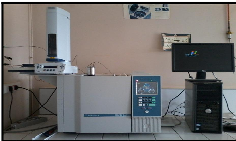
**Figure II.20** : Appareil de la chromatographie en phase gazeuse.
