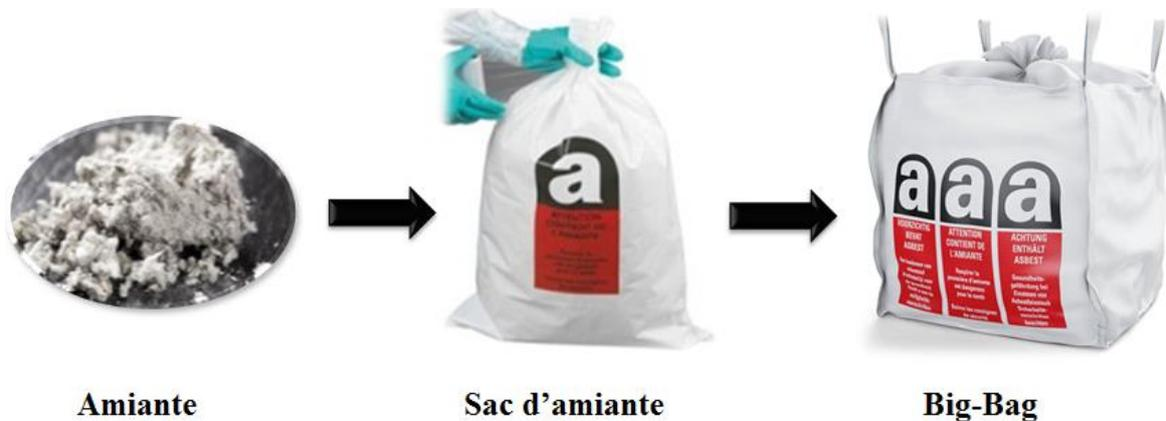
**Figure III.2:** Schéma de stockage des déchets amiantés.
