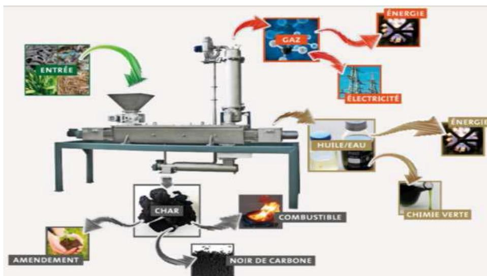
Figure II.5: Schéma de la pyrolyse.
