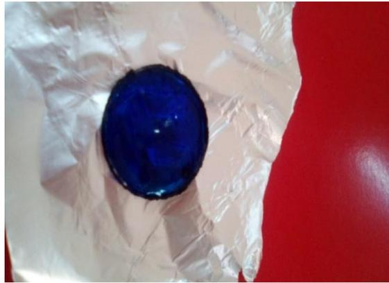
**Figure13.** Réseau de copolymère gonflé dans une solution colorée.
