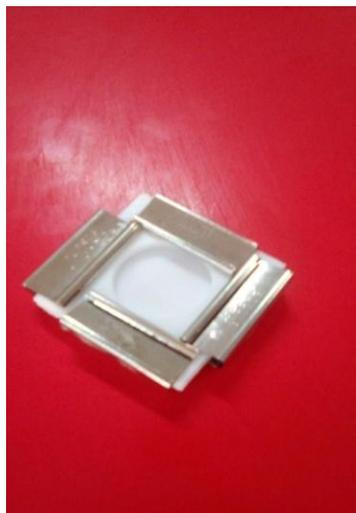
**Figure2.** Moule en téflon.
